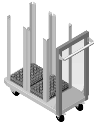
Abb. 5.3.2. a. Zuführungswagen b. Einfachzuführband für drei Behälterstapel
